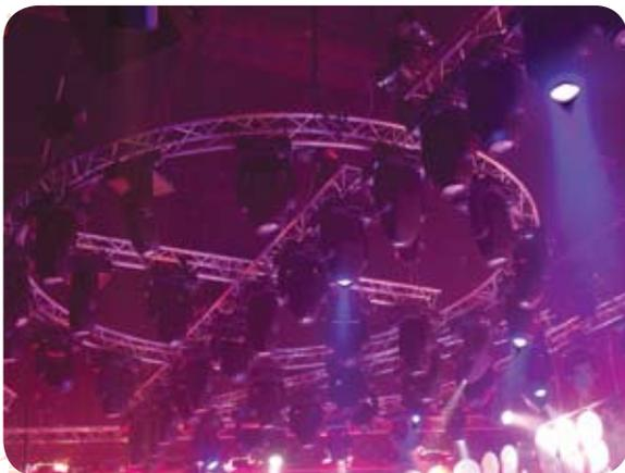
Los arreglos de Robe en los Carrère Studios están colgados en un *truss* también provisto por Impact Evénemet, diseñado para combinar con la imagen del escenario del estudio en forma de ondas, anillos y curvas. Las secciones del *trussing* se ensamblaron de manera individual antes de ser colocados en el techo.
